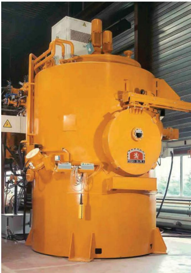
Fig. 7. Forno a vácuo de óleo tipo P164TH
